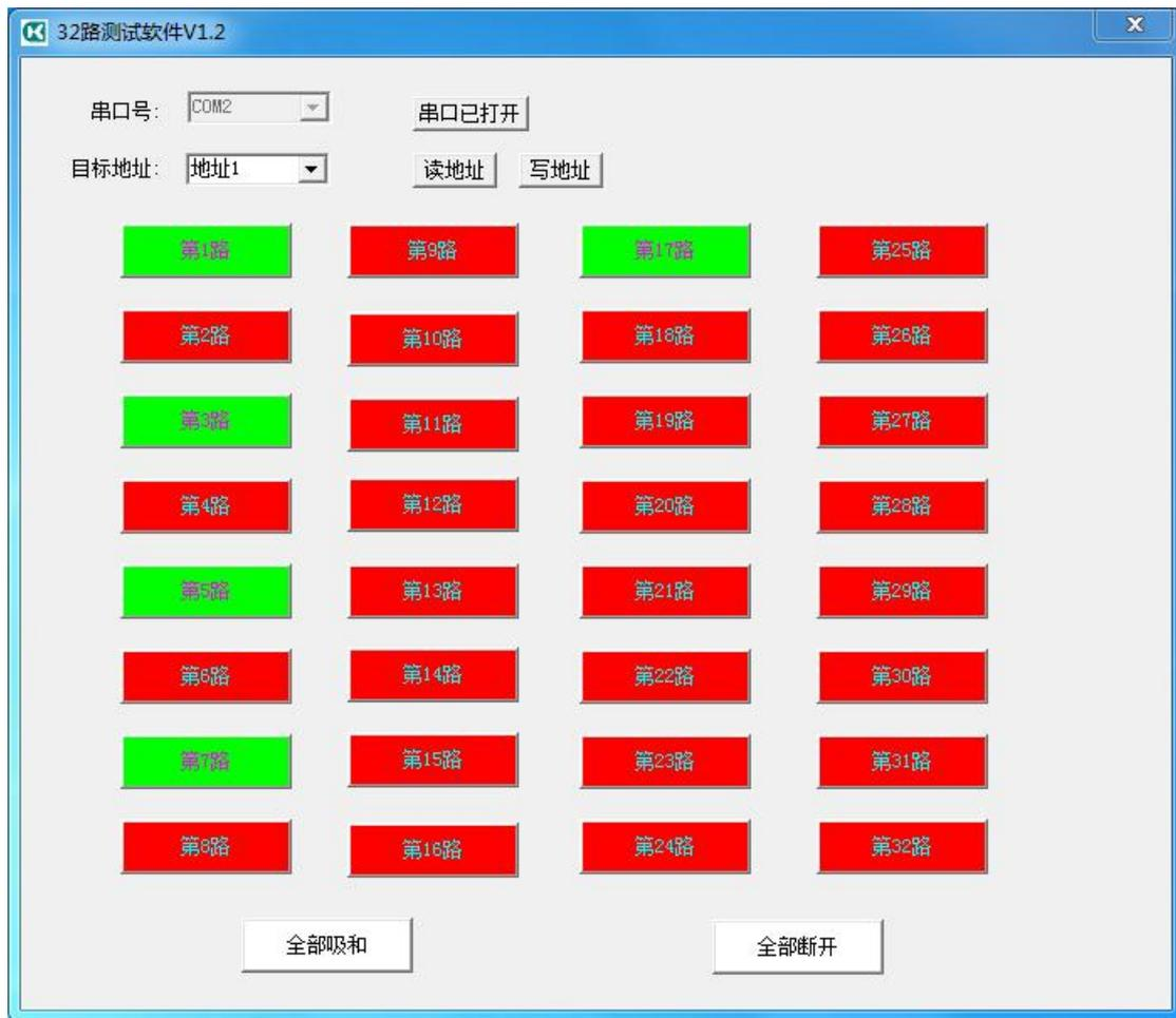
上图为继电器控制板与软件连接成功后图示，软件可以控制继电器动作，也可以显示输入和输出的状态，软件图标红色代表断开，绿色代表闭合。输入输出产品：1-16路代表1-16路继电器输出，17-32路代表1-16路输入。
