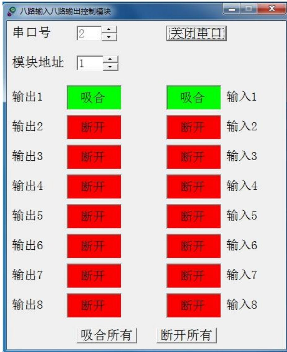
上图为继电器控制板与软件连接成功后图示，产品出厂设置地址为1，软件可以控制继电器动作，也可以显示输入和输出的状态，软件图标红色代表断开，绿色代表闭合。
